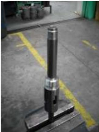
DESPLAZAR EL RESORTE ( 07 ) POR EL ASIENTO DE CONO ( 05 ) Y COLOCAR LOS ESPACIADORES CORRESPONDIENTES SEGÚN LA REGULACIÓN DEL CAUDAL DEFINIDO. LUEGO APLICAR UNA DELGADA PELÍCULA DE LOCTITE 242 SOBRE LA ROSCA Y ENROSCAR EL ORIFICIO ( 09 ) AL ASIENTO DE CONO ( 05 ) COMO MUESTRAN LAS SECUENCIAS DE FOTOS.
