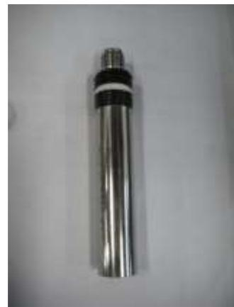
TOMAR EL PORTA EMPAQUETADURA P/ CONO ESPINADO ( 03 ) Y COLOCAR EL CONO ESPINADO ( 04 ) DENTRO DE SU INTERIOR, LUEGO SUJETAR EL PORTA EMPAQUETADURA P/ CONO ESPINADO ( 03 ) CON LA MORSA PARA CAÑO Y COLOCAR LA ESPINA ELÁSTICA ( c ).
