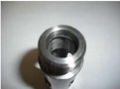
COLOCAR UNA DELGADA PELÍCULA DE GRASA SILICINADA SOBRE EL O´RING PARA PODER DESPLAZAR CON FACILIDAD EL ASIENTO DE CONO ( 05 ) POR SU INTERIOR.
